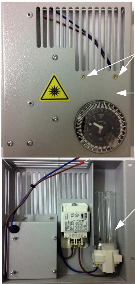
Il generatore di ozono utilizzato consente un'efficace disinfezione per 2000 ore di funzionamento, dopo di che il generatore di ozono va sostituito. Una volta al mese eseguire un controllo visivo del generatore di ozono durante il funzionamento. Sulla parete posteriore dell'apparecchio si intravede una luce azzurrina.
